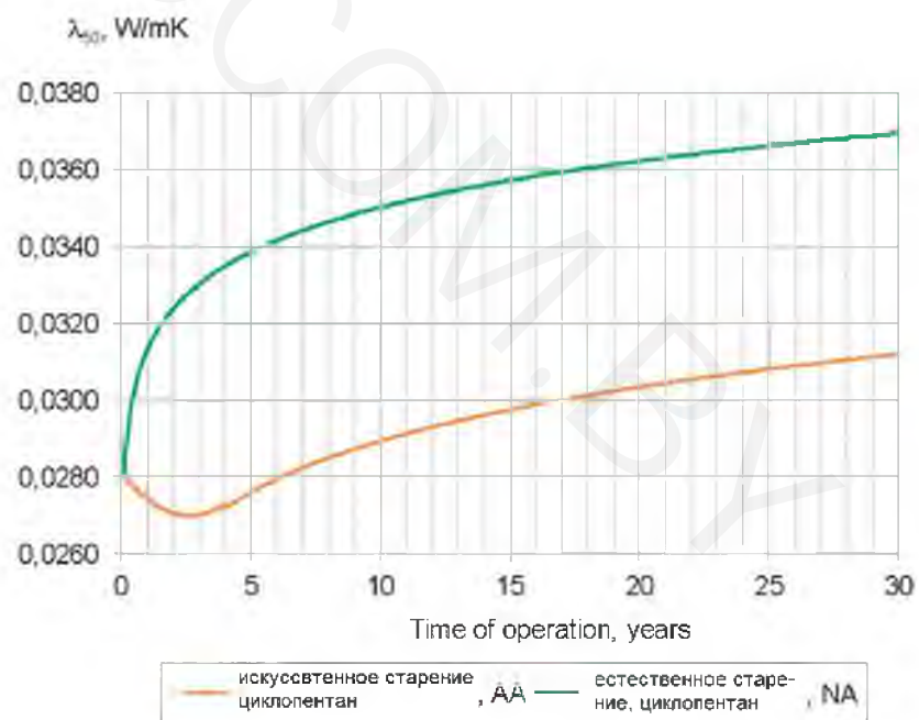
Рисунок 9 - Коэффициент теплопроводности изоляции, вспененной циклопентаном после искусственного (AA) и естественного старения (NA)
